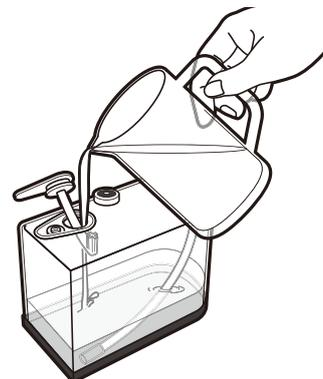
**3** 給水タンクに水道水(飲用)を入れ、キャップを閉めて軽く振って洗い流してください。
